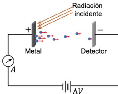
Cuando una radiación de frecuencia  $\nu$  incide sobre una placa metálica arranca electrones. Sólo los que tengan  $K \geq \Delta V$  llegan al detector y producen una corriente eléctrica.
