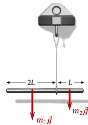
la energía potencial gravitatoria del sistema es únicamente la debida a la pesa, porque el centro de masas de la barra no ha cambiado de posición. Entonces
