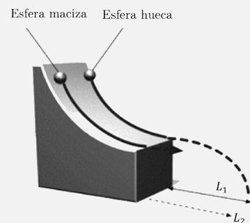
Consideremos la situación en la que las dos esferas están en reposo en la parte superior de la rampa, a una altura  $H$ . Si definimos el origen de energía potencial gravitatoria en el suelo, entonces ambas esferas tienen una energía mecánica igual a su energía potencial gravitatoria a esa altura  $H$ . Es decir,
