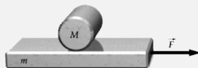
Las fuerzas que actúan sobre el bloque son la externa,  $\vec{F}$ , y la fuerza de rozamiento debida al cilindro que está sobre él,  $\vec{F}_r$ , que se opone al movimiento del bloque y tiene, por tanto, el sentido de la figura. Por otra parte, sobre el cilindro actúa una fuerza igual en módulo a  $F_r$ , pero de sentido contrario. La segunda ley de Newton se escribe entonces, para el bloque y el cilindro, como
