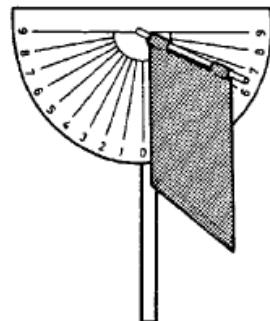
donde  $A$  es el área de la placa,  $n$  es el número de partículas del fluido por unidad de volumen,  $m$  es la masa de una partícula de fluido,  $v$  es la velocidad de las partículas de fluido y  $\alpha$  es el ángulo entre la dirección del fluido y la normal a la placa.
